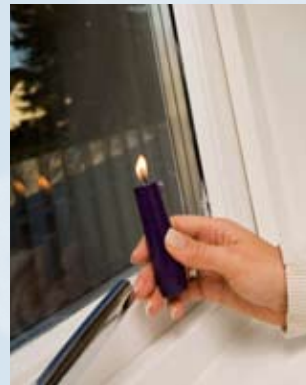
Test om du har du lavenergivinduer: Hold en flamme skrått mot vinduet - dersom en av flammene har en annen farge enn de øvrige, er det sannsynlig at du har et energiglass.
